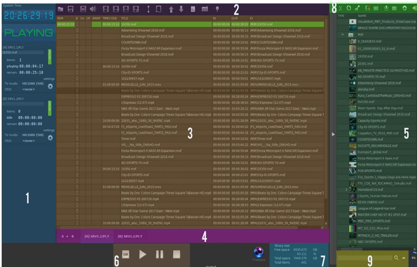
Le logiciel **TheCorePlayerUI** permet de contrôler (piloter) le serveur TheCore en mode playout (lecture). La machine qui héberge l'application TheCorePlayerUI est équipée d'un carte GPI permettant de signaler les différents états de l'application et de démarrer une playlist de diffusion ou simplement un clip (programme).
